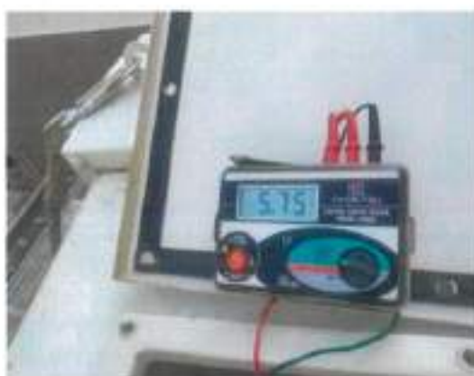
ค่าการลัดลงดินของตัวถัง (Tank)
