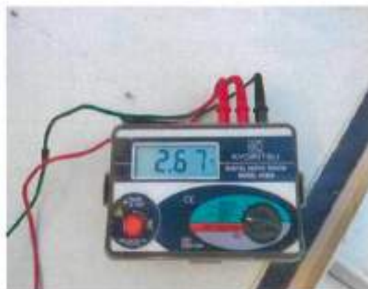
ค่าการวัดจุดต่อของดินของนิวทรัล (Neutral)
