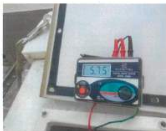
ค่าการลัดลงดินของกับดักไฟฟ้า (Lightning Arrester)
