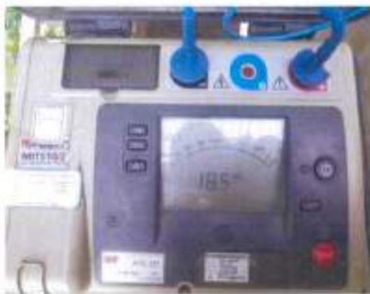
ค่าความต้านทานระหว่างขั้วแรงสูงกับแรงต่ำ HV-LV
