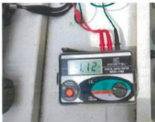
ค่าการวัดจุดต่อดินของตัวถัง (Tank)
