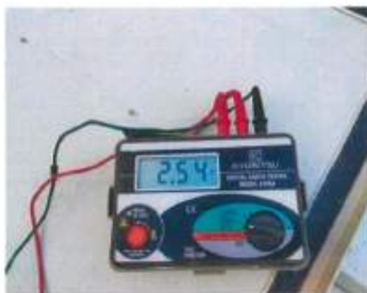
ค่าการวัดจุดต่อของดินของกับสวิตช์ไฟฟ้า (Lightning Arrester)
